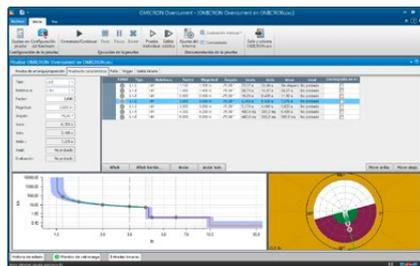
El software superpone las características de cada uno de los elementos en el diagrama I/t y en el diagrama direccional. Incluye todos los elementos que reaccionan al tipo de falla aplicada. Para cada disparo de prueba se realiza una evaluación del desempeño del relé basado en las tolerancias permitidas para la medición de la corriente y el tiempo de operación.
