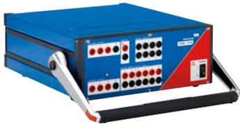
El equipo CMC 310 está específicamente diseñado para las pruebas trifásicas manuales de dispositivos de protección y de medición con CMControl P. El diseño ligero y compacto hace que la unidad CMC 310 sea especialmente adecuada para pruebas de sistemas de distribución e industriales. Si se requieren pruebas automatizadas, se puede actualizar en todo momento la unidad CMC 310 a la unidad CMC 353.
